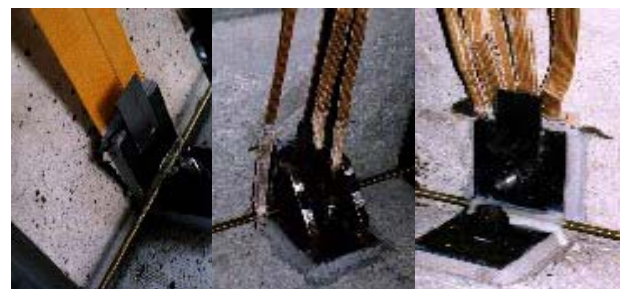
No.1-1 アングル降伏 No.5-2 シート破断 No.7-2 シート破断
